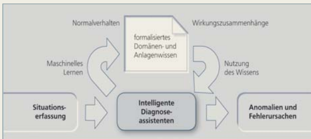
BILD 5: Maschinelles Lernen als Grundlage für Diagnose-assistenten
