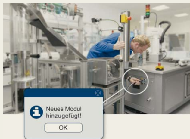
BILD 3: Automatische Systemintegration eines Anlagenmoduls in der Lemgoer Modellfabrik
